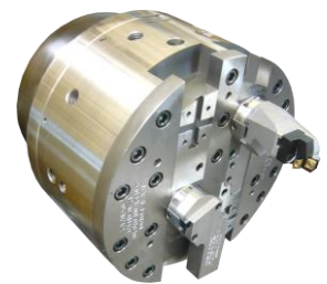
Plandrehkopf mit 2 CNC-gesteuerten Schiebern; mechanische Schnittstellen für anwendungsspezifische Werkzeughalter und Ausgleichsgewichte
